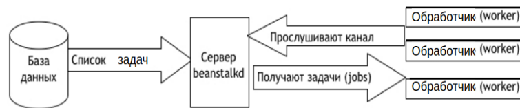
Рисунок 1 – Алгоритм обработки очереди
